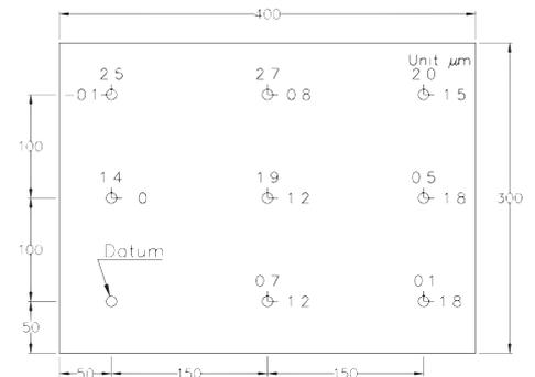
X軸節距精度： $-0.1\mu\text{m} \sim 1.8\mu\text{m}$
