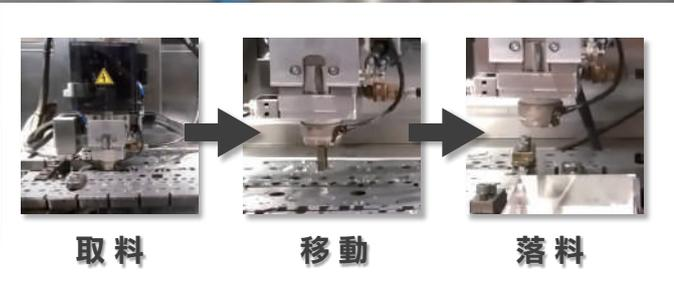
使用獨特的機構模組進行廢料移除，大幅節省人工，提升自動化程度，落實高效率生產。
