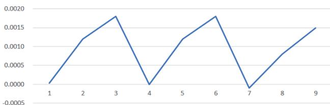
Y軸節距精度： $0.0\mu\text{m} \sim 2.7\mu\text{m}$
